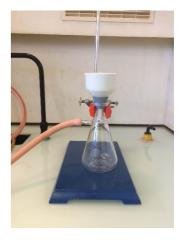
2. Connecter le tuyau de la pompe à vide ou trompe à eau, avec l'aspiration coupée.
