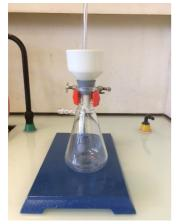
1. Fixer la fiole à vide fermement, à l'aide d'une pince à 2 ou 3 doigts. Ajuster l'entonnoir Büchner à la fiole à l'aide d'un joint en caoutchouc pour assurer l'étanchéité.
