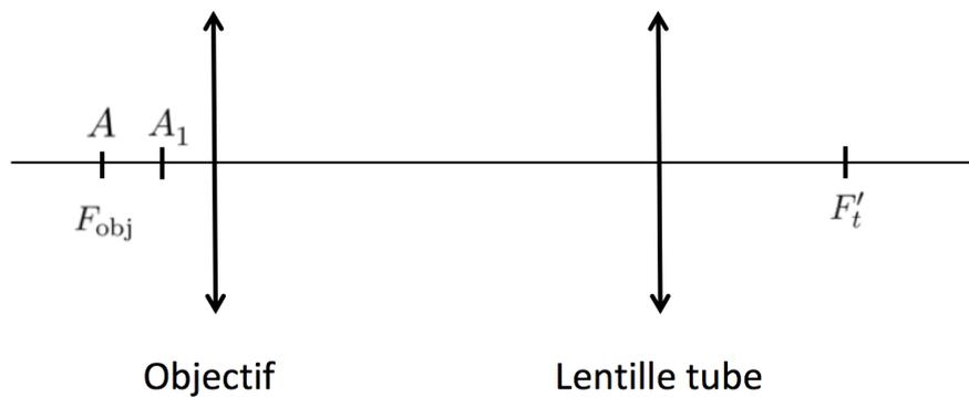
FIGURE 12 – *Système optique sans élément dispersif.*
