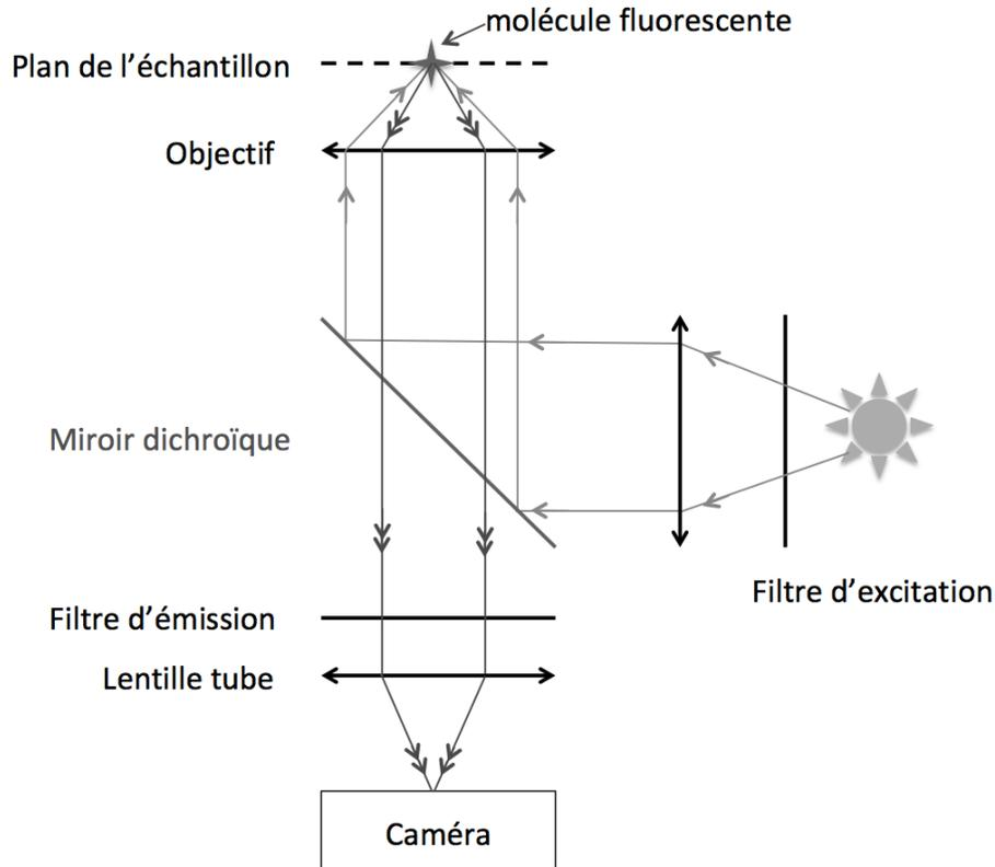
FIGURE 9 – Schéma du dispositif expérimental de microscopie par fluorescence. Le miroir dichroïque, ainsi que des filtres d'excitation et d'émission dans un microscope de fluorescence sont également représentés.
