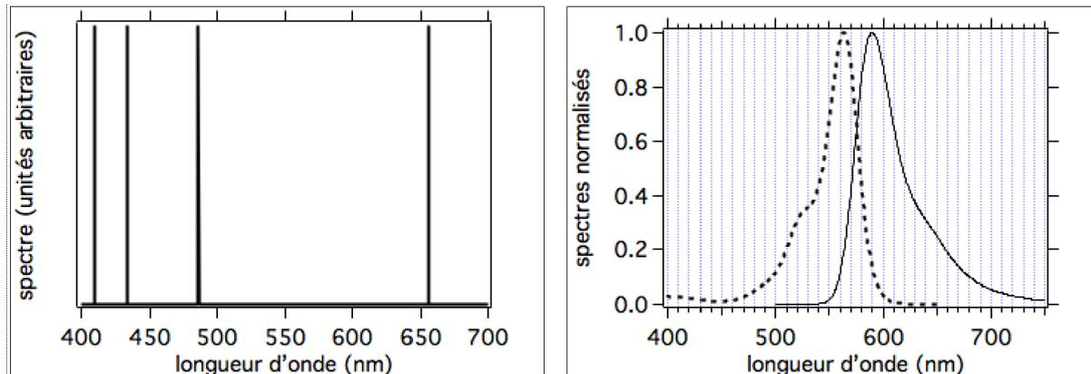
FIGURE 7 – À gauche : Spectre d'émission de l'atome d'hydrogène. À droite : Spectres normalisés d'émission et d'absorption de la molécule ATTO565<sup>TM</sup> tracés à partir des données disponibles sur le site *atto-tec.com*.
